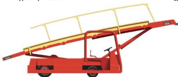
convoyeur M à bagages M baggage conveyor transportador M de equipaje M Gepäckförderer M nastro M trasportatore M dei bagagli M
